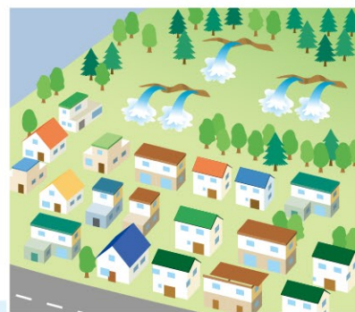
● 斜面から水がふき出す
