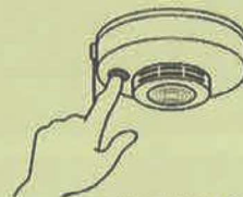
② 火災の早期発見のために、住宅用火災警報器を定期的に点検し、10年を目安に交換する
