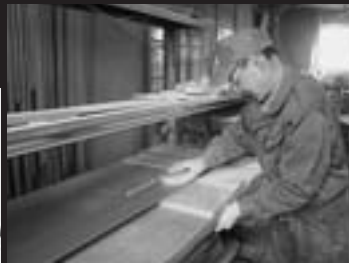
部材のやすり掛け作業 (1日300枚以上にもなります)
